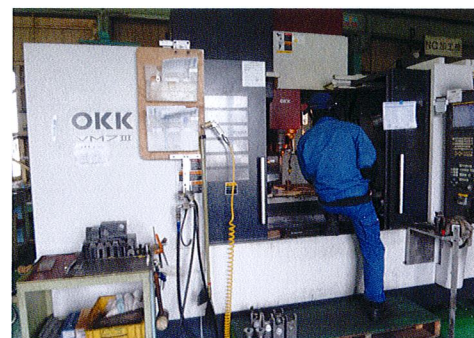
MC (マシニングセンタ) オペレーション作業
