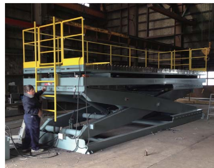
●蹴出し足場付き大型リフター
