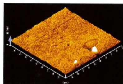
TiN膜表面AFMデータ
