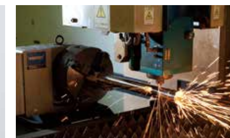
パイプのレーザ切断 200Aまで
