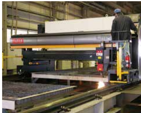
日酸TANAKA 6kWレーザ加工機
