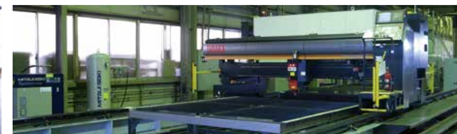
大板対応レーザ切断 3m×15mまで
